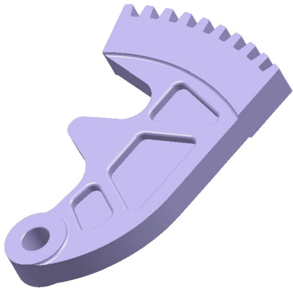
Segmenthebel mit Verzahnung
