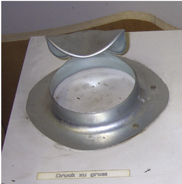
Abb. 2.4 Versuchsprobe – mit zu hohem Druck hergestellt. Anmerkung: Die Fehlstelle ist hier der durchgerissene Boden. (Eigene Darstellung)
