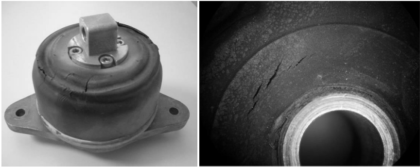
Abbildung 2.1: Thermisch bis zur Zerstörung gealterte Elastomerbauteile [15]
