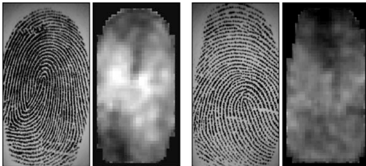
Abb. 2.14 Frequenzbild von zwei Fingerabdrücken. Helle Bereiche bzw. Blöcke lassen hohe Frequenzwerte erkennen. Hingegen kennzeichnen dunkle Blöcke niedrige Frequenzbereiche [33, 34]
