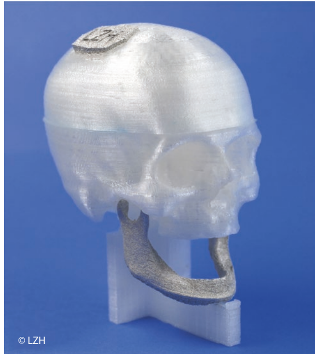
Abb. 6 Laseradditiv gefertigte Kiefer- und Schädelimplantate
