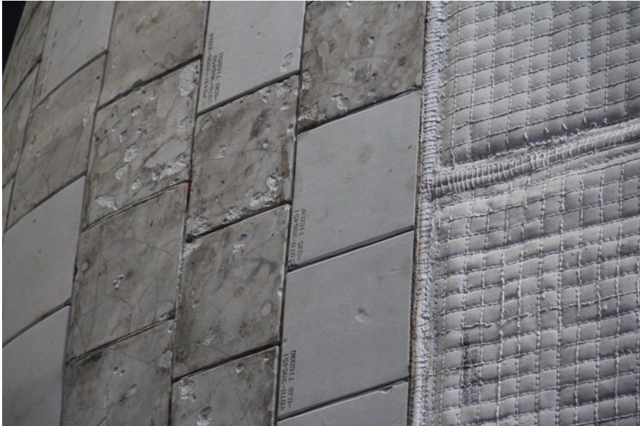
Abb. 2.7 Hitzeschutz auf der Oberseite des Space Shuttles Atlantis. Die stärker aufheizenden Regionen (links) sind mit Hitzeschutzkacheln belegt, die weniger stark aufheizenden (rechts) mit Nomex-Gewebe abgeschildert
