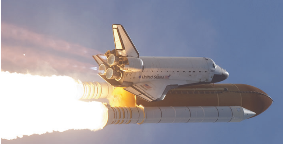
Abb. 2.14 Mach'sche Knoten sind in den Triebwerksstrahlen der wasserstoffbetriebenen Spaceshuttle Haupttriebwerken sichtbar, in denen sich Schallwellen innerhalb des Triebwerksstrahls refokussieren. (Bildquelle: NASA)
