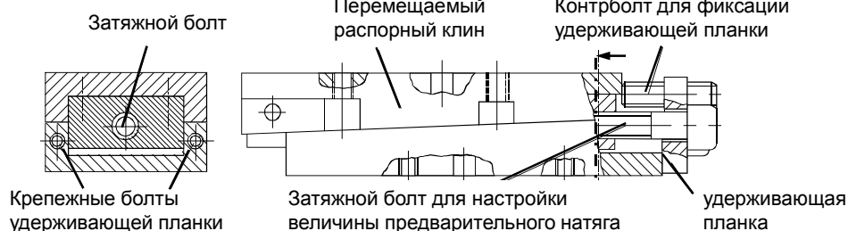
Рис. 6-3: Направляющие стола сверлильного станка с ЧПУ с устройством преднатяга
