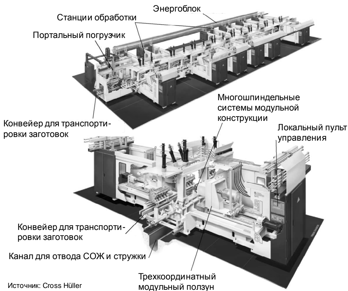
Рис. 1-7: Автоматическая линия с жесткой транспортировкой (трансферная)
