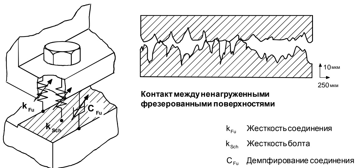
Рис. 3-22: Описание резьбового соединения через характеристики упругих демпфирующих элементов
