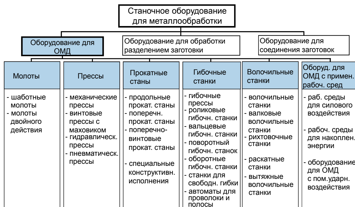
Рис. 1-9: Оборудование для обработки металлов давлением ОМД (DIN 8580, DIN8582)
