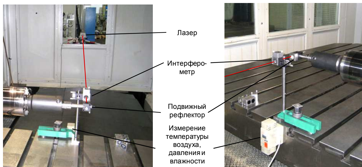
Рис. 7-22: Лазерный интерферометр. Измерение точности позиционирования обрабатывающего центра
