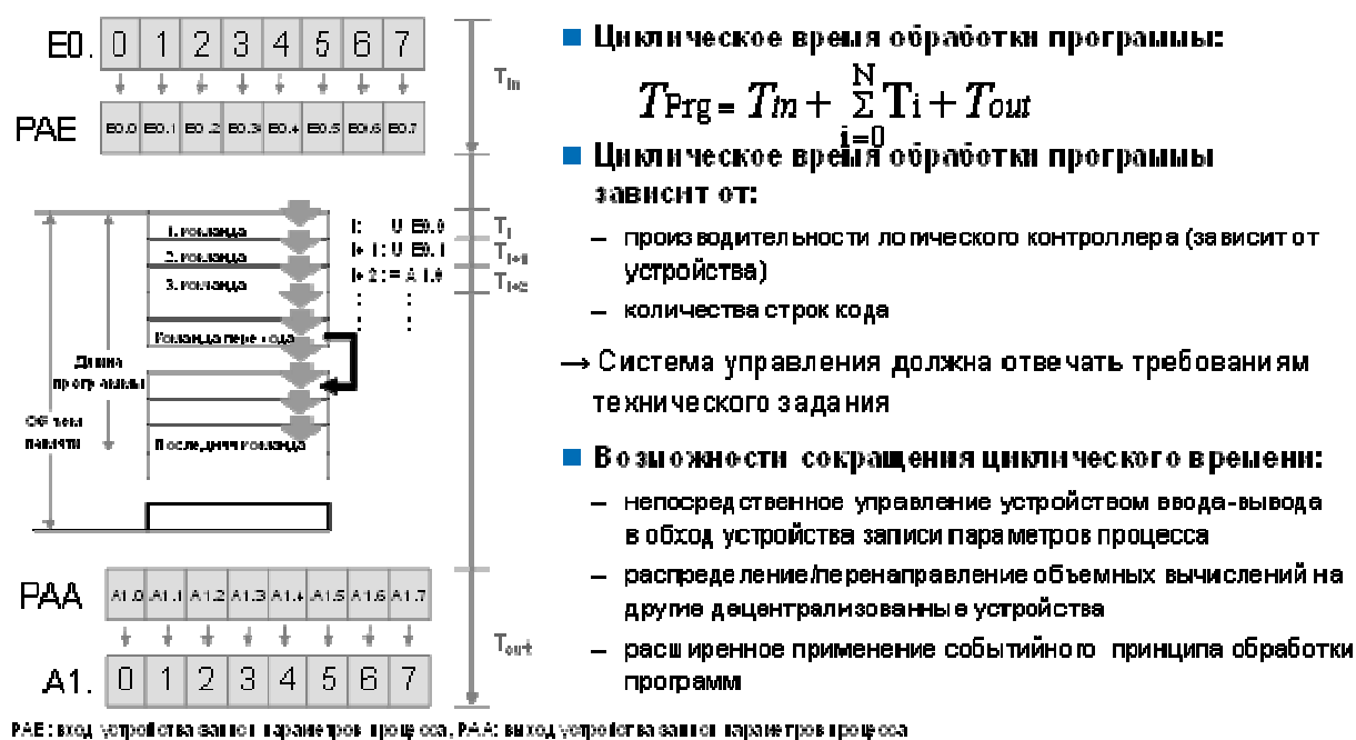
Рис. 12-9: Принцип действия системы SPS – программный цикл
