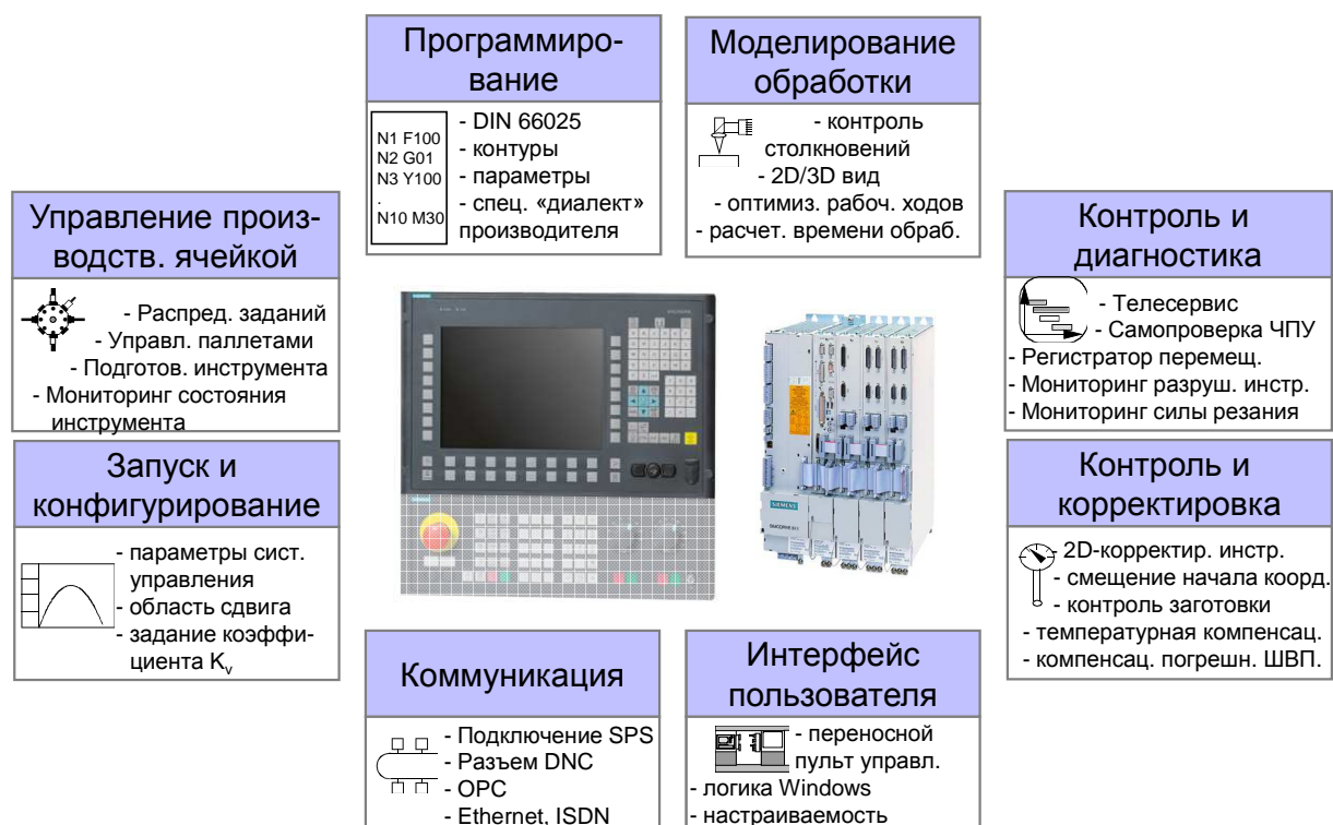
Рис. 12-12: Функции системы числового программного управления
