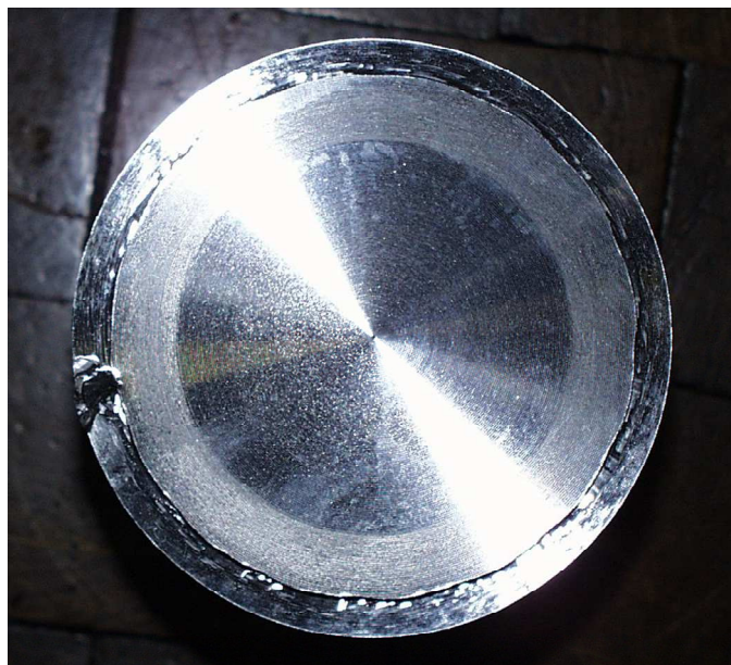
Пример нестабильно обработанной заготовки. Повреждение поверхности заготовки вследствие регенеративного эффекта.
