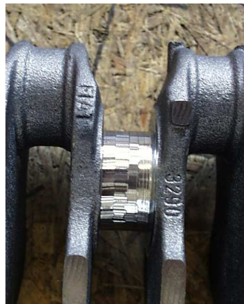
Повреждение поверхности седла подшипника коленчатого вала в виде огранки.
