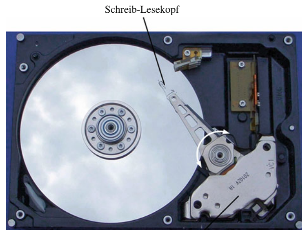
Positionieren des Schreib-Lesekopfes eines Festplatten-Laufwerks
